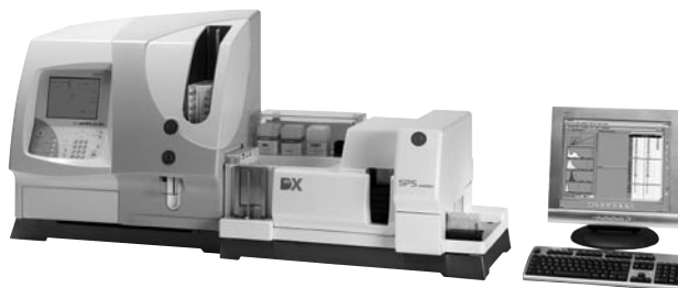
Rys. 1. Analizator Pentra DX 120 z modulem do automatycznego przygotowywania rozmazów (SPS Evolution) do różnicowania krwinek i oceny ich populacji.
