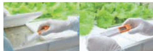
▲コンパクトイオンメータによる養液成分の測定。
