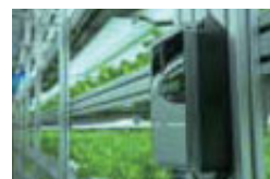
▲炭酸ガスモニタによる栽培室内のCO2測定
