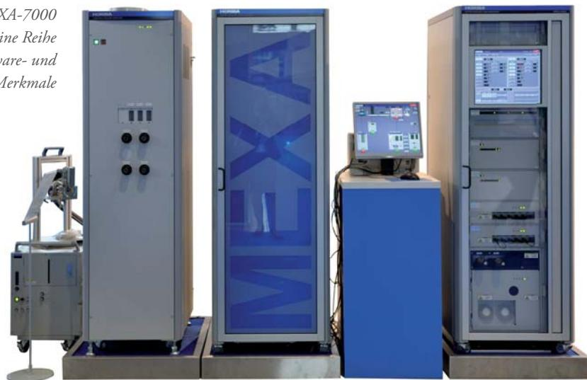
wendungsbereich resultiert aus dem breiten Spektrum an Analysatoren, die alle von HORIBA selbst entwickelt und hergestellt werden. Erstmals implementiert HORIBA die beiden neuen Analysegeräte auf Basis der Quantenkaskadenlaser-Technologie elektrisch, physisch und steuerungstechnisch in die MEXA-7000 Version 4.
