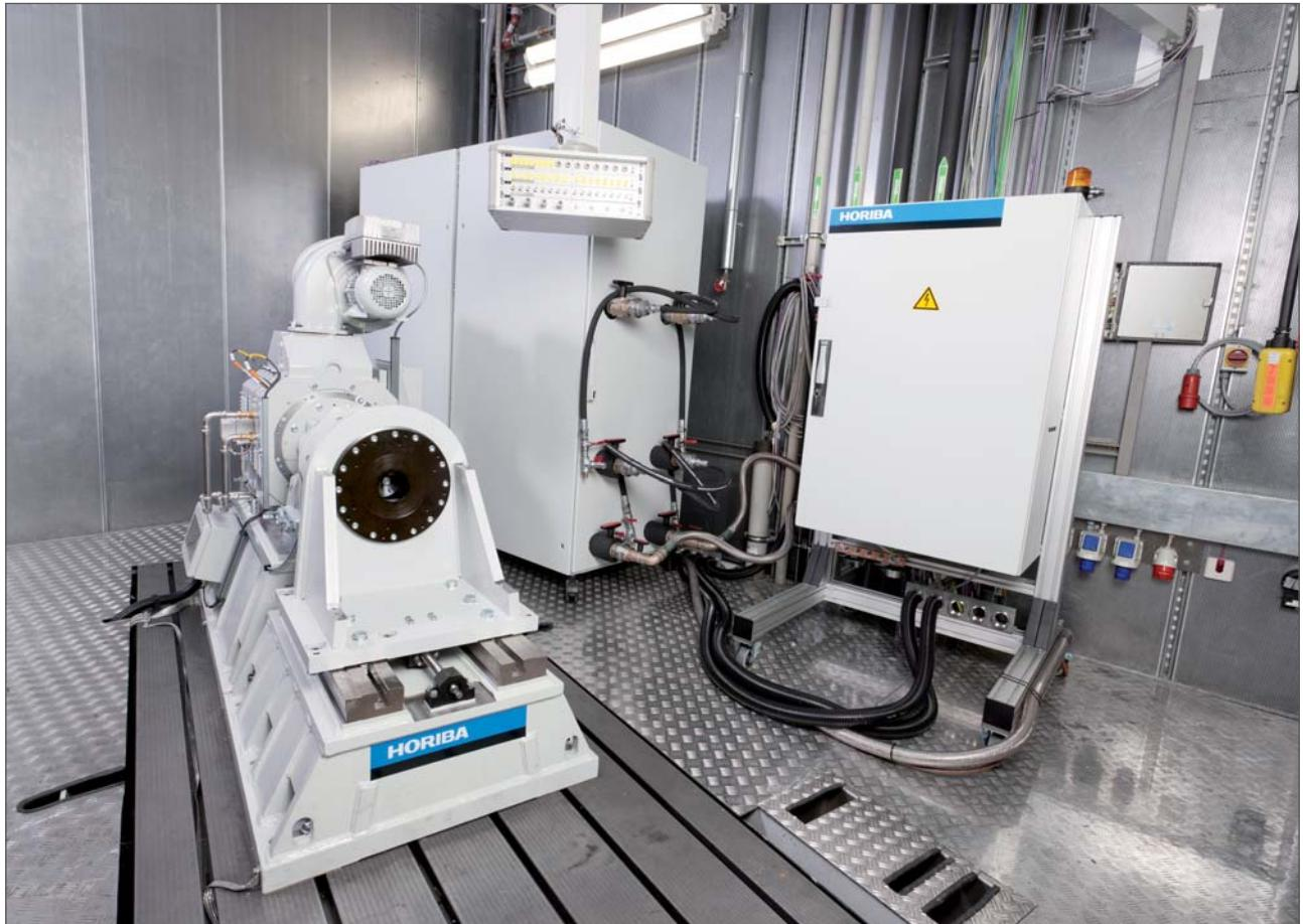
HORIBA nahm Anfang September im Testcenter in Oberursel seinen neuen E-Motorenprüfstand in Betrieb. Zusätzlich zum bereits bestehenden Fahrzeugrollenprüfstand und dem Motorenprüfsystem steht damit nun in der dritten Prüfzelle ein hochmodernes Testsystem zur Verfügung. Wie in den TITAN-Motorenprüfständen für konventionelle Verbrennungsmotoren verwendet HORIBA auch beim TITAN E-Motorenprüfstand die leistungsfähige Kombination aus dem hauseigenen SPARC-Controller und der STARS-Prüfautomatisierung.
