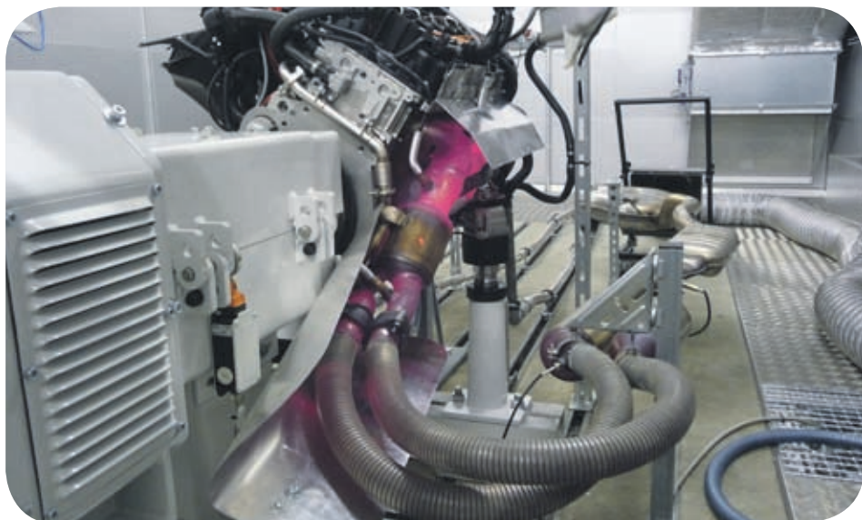
Glühende Abgasanlage - Keine Seltenheit in der Fachhochschule Schweinfurt
