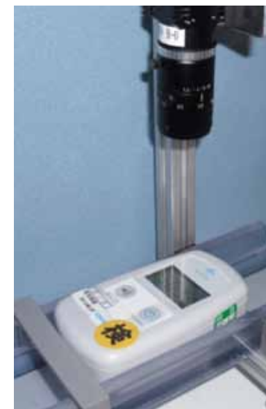
福島サービスステーション 環境放射線モニターの校正設備を 自動化
