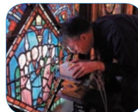
使用远程拉曼光纤探头，研究巴黎圣母院 13 世纪彩色玻璃窗
