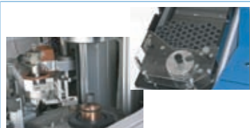
氧氮氢分析仪配置坩埚自动装填装置和自动清扫与除尘系统，实现单机分析过程的全自动化。
