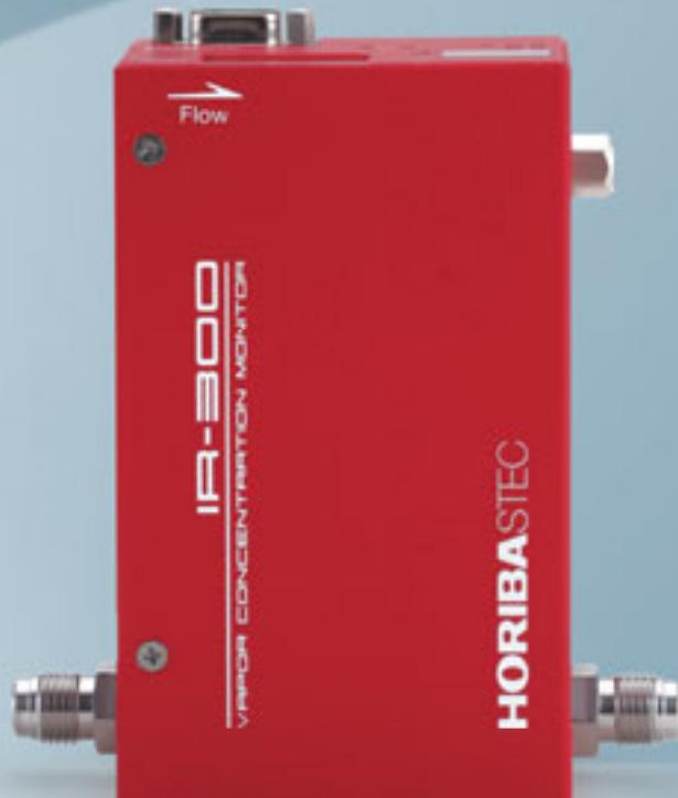
非分散型赤外線吸収法は、赤外光源から放射された赤外光が、ガス分子により吸収される現象を利用しています。IR-300 Seriesは、測定対象ガスの吸収をもつサンプル出力と、吸収をもたないリファレンス出力を比較しガス濃度に変換しています。このダブルビーム方式の採用により、長期的に安定した測定が可能となります。
