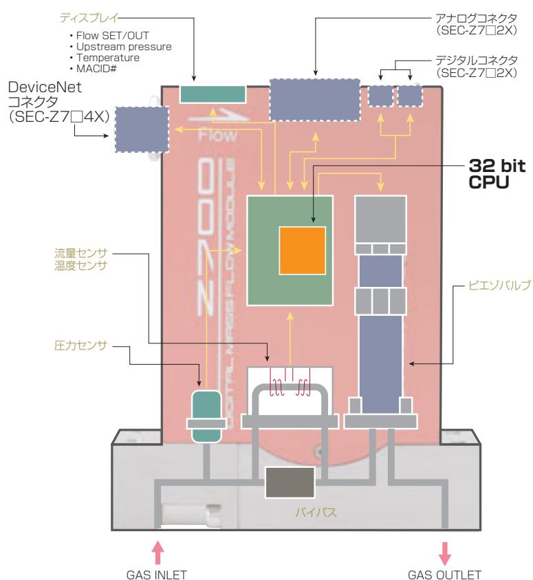
ガスはInlet 継手部より導入され、流量センサとバイパスに分流されます。センサによりガスの質量流量を計測し、外部より与えられる流量設定信号と計測した流量の変位かゼロと成るように流量制御バルブが流量を制御します。供給圧力を圧力センサによりモニタリングし、一定以上の急激な圧力変動時には新開発のVariable Control Mode 機能が動作し、安定した流量制御を行います。制御部にループ回路を採用し、導入ガスの供給圧力や二次側圧力変化や周囲温度変化等が生じた場合でも瞬時に流量補正を行い安定した流量制御が行えます。
