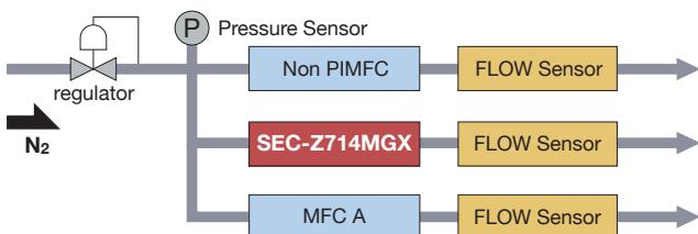
同一ガスラインを分岐し、PI機能を搭載していないデジタルMFCとPI機能を搭載したSEC-Z714MGXの供給圧力変動に対する流量制御性を確認するテストフローです。MFC Aの制御流量を瞬時に変更する事により、供給圧力の変動を意図的に発生させます。
