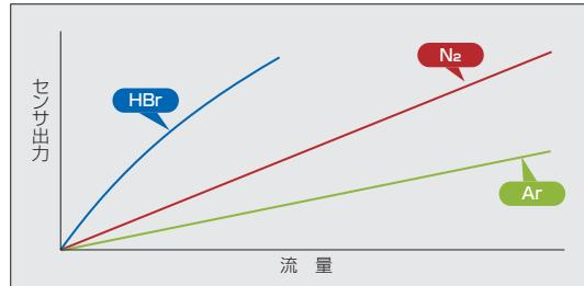
プロセスに使用されるガスは様々な物性を持っています。SEC-Z700Xシリーズは、プロセスガス固有の流量特性を反映した流量レンジ毎の計測値、信頼性の高い流量センサ、最新の補正アルゴリズムを融合した高度な流量制御を行います。
