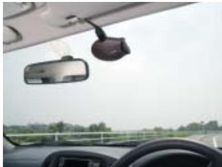
ドライブレコーダーとは自動車などのフロントガラスに取り付けたカメラで前方の様子を撮影しつづけ、事故(一定以上の衝撃)を感じるとその時点の前後十数秒間の動画を記録する装置です。飛行機のフライトレコーダーのように事故の様子を記録するドライブレコーダーは、事故時の証言者として近年注目され、タクシー業界などの輸送機関で普及が進んでいます。今後は単なる事故状況の解析にとどまらず安全運転教育や指導にも活用でき、交通事故そのものの抑止効果にもつながると考えられます。当社の「どら猫」(商品名)は、映像だけでなく、GPSを用いた位置情報、スピード、ブレーキ操作の有無、方向指示器などの情報も合わせて記録するユニークな特徴を持っています。
