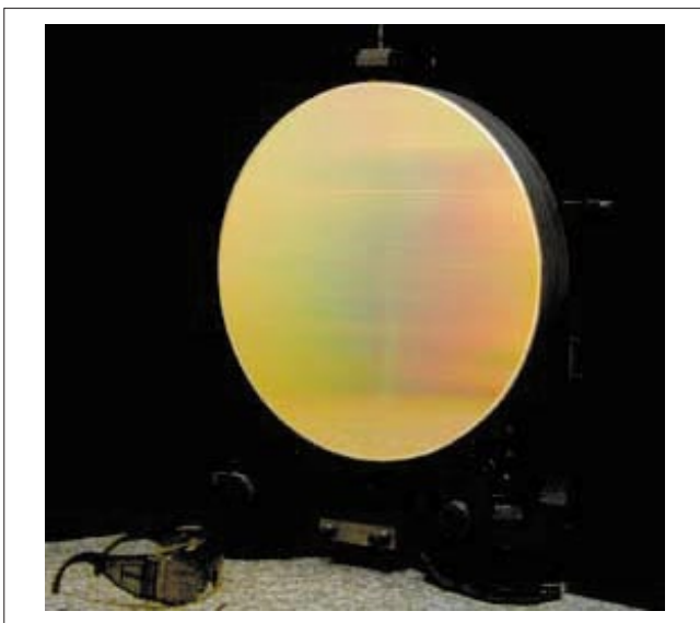
図2 1.053 \mu\text{m} レーザ用グレーティング(金コーティンググレー ティング溝密度:1740本/mm ,ブレース波長(最大効率波長): 1.053 \mu\text{m} ,直径420 mm)
